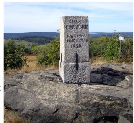
Triangulation. Er trägt die Nr. 82 und diente der Landvermessung. In den Jahren 1862 bis 1890 wurde auf dem Staatsgebiet des Königreiches Sachsen die Landvermessung durchgeführt mit gleichzeitiger Erstellung eines trigonometrischen Netzes. Das Vermessungsnetz umfasste ca. 16.000 km<sup>2</sup> mit 158 Säulen, die im Abstand zw. 20 und 50 km zueinander standen.
